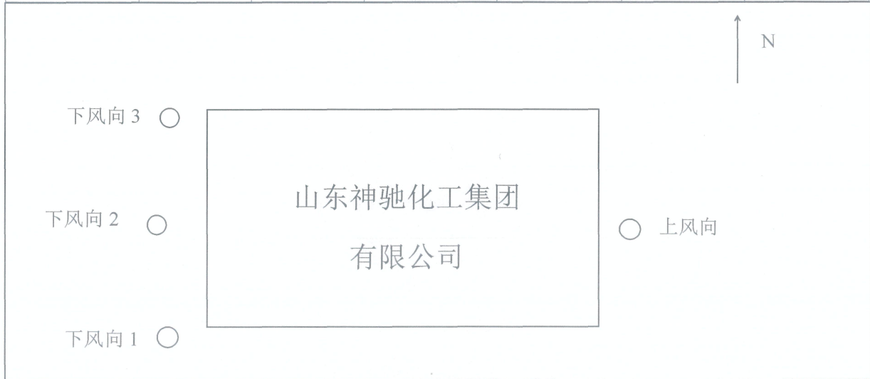
图 1 无组织废气采样布点图
